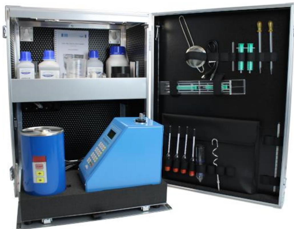
**BRENNSTOFF- UND SCHMIERÖL-TESTKABINETT Grundversion inkl. Reagenzien und Zubehörteilen**
