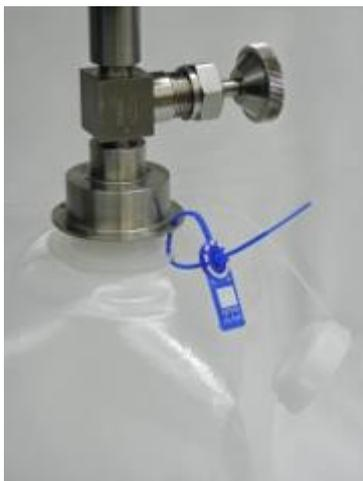
Während des gesamten Bunkervorganges wird der Cubitainer direkt an den DRIP SAMPLER PRESSURE PLUS befestigt und mit einem einzelnen nummerierten Siegelstreifen luftdicht verschlossen. Diese Zusammensetzung schützt zuverlässig vor einer Manipulation oder einer externen Verschmutzung der Brennstoffprobe während der Dauer der Bunkerlieferung.
