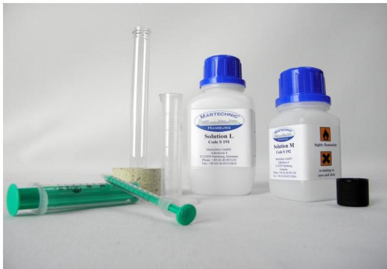
Um die Existenz der Säure in Öl zu bestimmen, werden zwei Reagenzien (der Indikator und die Titrationsflüssigkeit) vermischt bis ein Farbumschlag ins Grüne erfolgt. Danach wird die Ölprobe hinzugefügt, und die Farbe der gut geschüttelten Flüssigkeit wird wieder rot, falls die Säure vorhanden ist.
